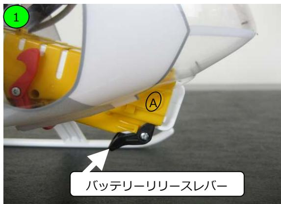
1. A部分の両側を親指と人差し指で押してください。バッテリーのロック爪はAの部分を押すことで、ロック爪部分が起き上がってロックが外れるようになっています。
