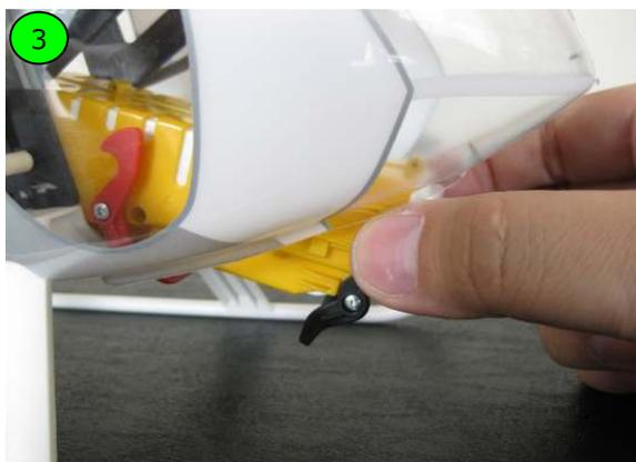
3. A部分を押したまま中指でバッテリーリリースレバーを手前に引き、バッテリーを取り出します。必ずロックが外れたことを確認してからバッテリーリリースレバーを手前に引くようにしてください。
