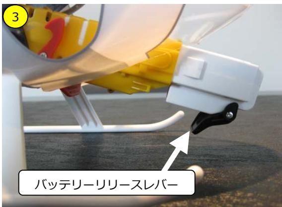
3. バッテリーを途中まで装填し、バッテリーリリースレバーをバッテリーの装填方向に倒した状態にしてください。
