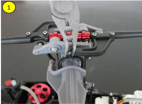
1. ボールリンクをボールリンクプライヤで外します。
