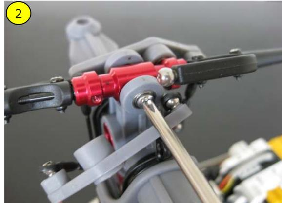
2. ミキシングレバー、スタビライザーシーソーを固定している4箇所のネジを外します。
