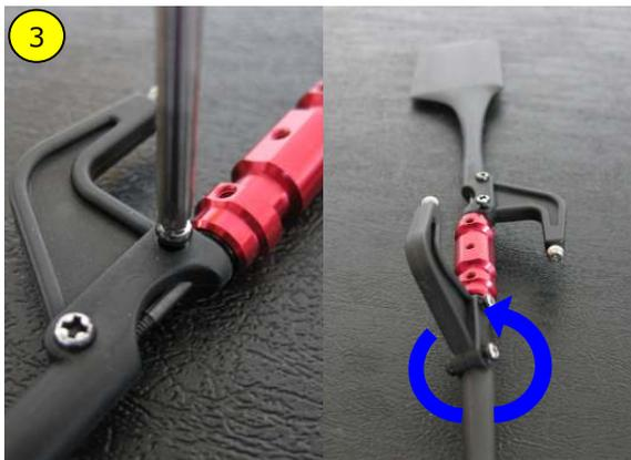
3. スタビライザーのネジを緩めます。(4箇所) スタビライザーパドルを回して片側のスタビライザー・パドルを取り外します。
