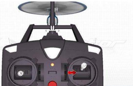
ホバリングしているとき、スロットルスティックの位置が中心より下ならば、両方のローターのリンクを同時に同量だけ伸ばしてください。
